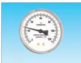
Cassa: in acciaio zincato - Trasparente: in plastica - Gambo: posteriore centrale in acciaio zincato - Precisione: Cl.2 - Elemento termometrico: spirale bimetallica - Guaina: in ottone - Grado di protezione: IP31
